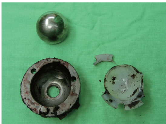
▲圖右下角為磨穿破損的白色墊片，圖左下角為磨損的金屬元件，沾有黑色金屬汙泥。
