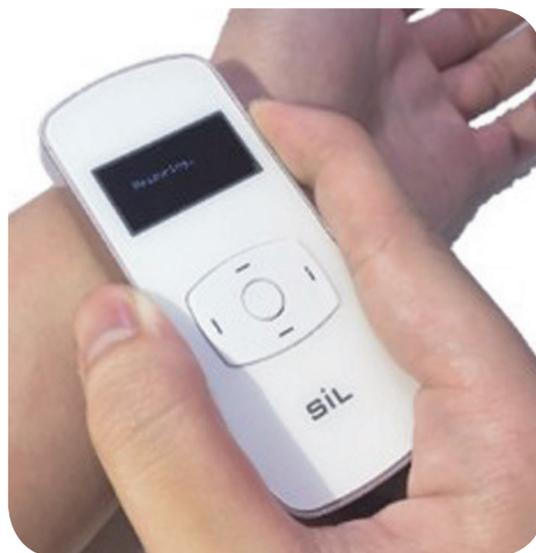
▲體積小巧且操作容易的手持式光學感應透析血管血流偵測器, 可及時掌握血管血流情形。
