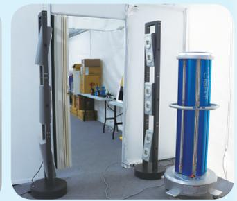
▲圖：入口2座立式大型紫外光抑菌燈及紫外線滅菌機器人(右)
